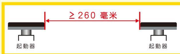
圖一：雙手控制裝置的起動器距離
