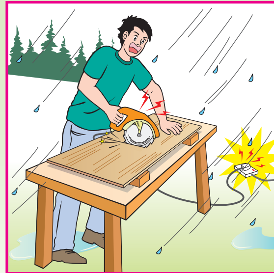
การใช้เลื่อยวงเดือน ไฟฟ้าที่มีสายดินขัดข้องบนพื้นเปียกอาจทำให้เสียชีวิตได้
